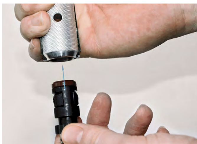
Colocação do cartucho de fixação KS no alicate de montagem KS
