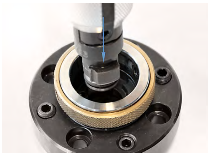
Colocação do cartucho de fixação KS
