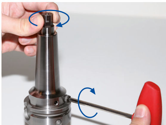
Figura 1: Girar parafuso de fixação e item de teste de ferramentas
