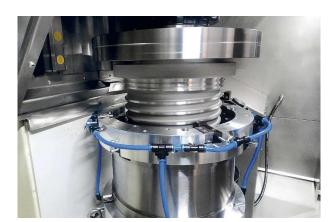
Bei der simultanen Bearbeitung wird das Werkstück von oben in den Ringspalt zwischen dem Außenwerkzeug und dem Innenwerkzeug gefahren. Bei der Zerspanung wird dabei mit reichlich Kühlschmierstoff gearbeitet. © NILES-SIMMONS-HEGENSCHEIDT GmbH
