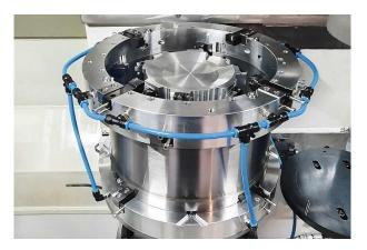
Das Semischlichtwerkzeug für die Innenbearbeitung ist in der unteren Spindel gespannt. Umschlossen wird es vom glockenförmigen Außenwerkzeug, das fest montiert ist. © NILES-SIMMONS-HEGENSCHEIDT GmbH
