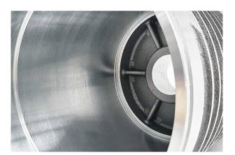
Die Zerspanung des Statorgehäuses umfasst die Innenbearbeitung mit verschiedenen Absätzen, die Bearbeitung der kleineren Mittenbohrung sowie die Bearbeitung der Außenseite mit ihren Kühlrippen. © NILES-SIMMONS-HEGENSCHEIDT GmbH
