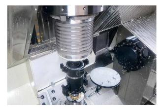
Die Fertigbearbeitung aller Innendurchmesser erfolgt mittels Feinbohrwerkzeug.
