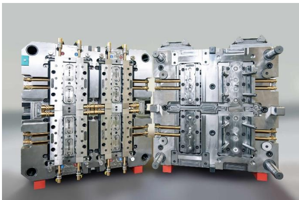
Ein fertiges Spritzgusswerkzeug. © Schülken Form
