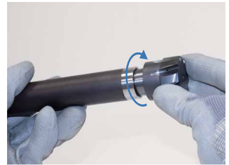
3. Avvitare a mano la testina intercambiabile, in senso orario, sul relativo supporto per testina intercambiabile. Quindi serrare il supporto per testina intercambiabile, completo di utensile, nel supporto della macchina.
