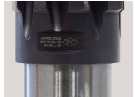
3. Avvitare a mano la testina intercambiabile, in senso orario, sul relativo supporto per testina intercambiabile. Quindi serrare il supporto per testina intercambiabile, completo di utensile, nel supporto della macchina.
