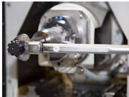
5. Stringere la testina intercambiabile utilizzando una chiave dinamometrica e la chiave fissa a innesto adatta (vedere la tabella "Coppie di serraggio delle testine intercambiabili").
