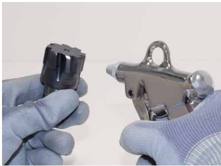
1. Pulire la testina intercambiabile passando aria compressa e un panno pulito su cono, filettatura e superficie piana.
