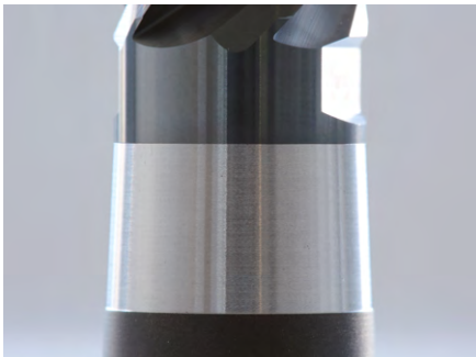
Resultado: Se cierra la separación entre el cabezal de fresado intercambiable y el portaherramientas para cabezal intercambiable, y se establece una unión en arrastre de fuerza y de forma. El cabezal de fresado intercambiable CPMill está preparado para funcionar.
