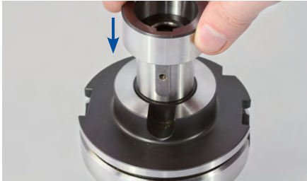
3. Colocar el primer anillo distanciador en el portafresa.
