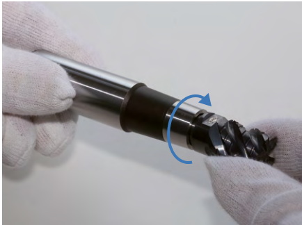
3. Enroscar manualmente el cabezal de fresado intercambiable en sentido horario en el portaherramientas para cabezal intercambiable. Seguidamente, sujetar el portaherramientas para cabezal intercambiable junto con la herramienta en el soporte de la máquina.
