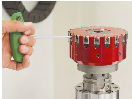
2. Aflojar el tornillo de sujeción del cartucho de fresar y extraerlo hacia arriba de la guía de cola de milano.
