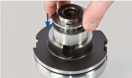
4. Colocar el segundo anillo distanciador en el primer anillo distanciador y el portafresa.
