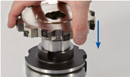
5. Colocar la herramienta de forma plana en el portafresa.
