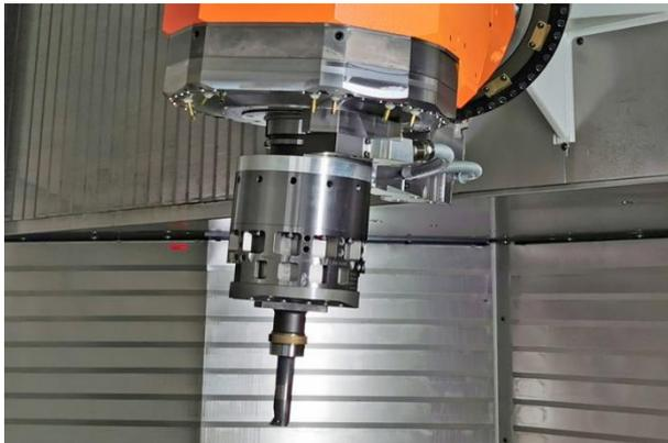
Das mechatronische Werkzeugsystem TOOLTRONIC installiert im Fräsdrehzentrum RX18 der Reiden Technik AG. © MAPAL
