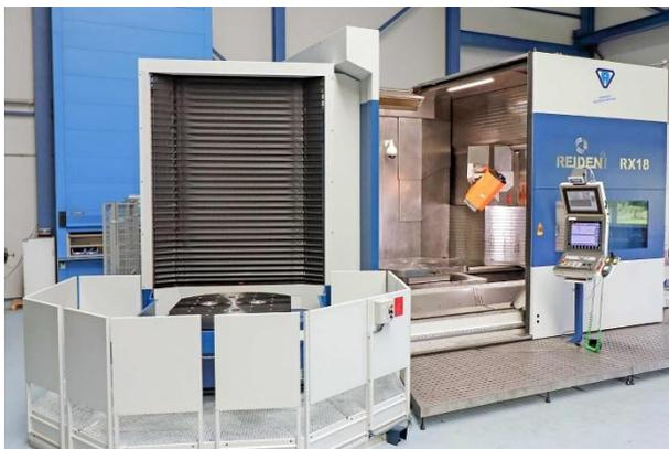
Die Reiden RX18 ist ein vielseitig einsetzbares 5-Achs-Fräsbearbeitungszentrum, das mit einem angetriebenen Drehtisch zum Fräs-Drehzentrum ergänzt werden kann. © Reiden
