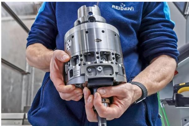
Die TOOLTRONIC mit linearem Aussteuerwerkzeug wird über die HSK100-Schnittstelle an der Spindel eingewechselt. © MAPAL
