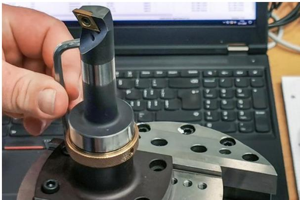
Der Drehmeißel wird auf dem Schlitten montiert. © MAPAL
