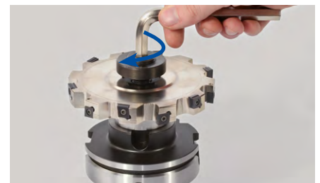
8. Dokręcić śrubę do mocowania frezu dalej w kierunku zgodnym z ruchem wskazówek zegara za pomocą klucza imbusowego, a następnie za pomocą klucza dynamometrycznego (moment dokręcania – patrz tabela „Moment dokręcania śruby do mocowania frezu”).
