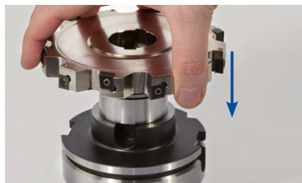
5. Umieścić narzędzie czołowo na trzpieniu frezarskim nasadzany.
