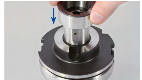
3. Nałożyć pierwszy pierścień dystansowy na trzpień frezarski nasadzany.
