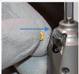
Abb. 8: Neue Wendeschneidplatte einsetzen
