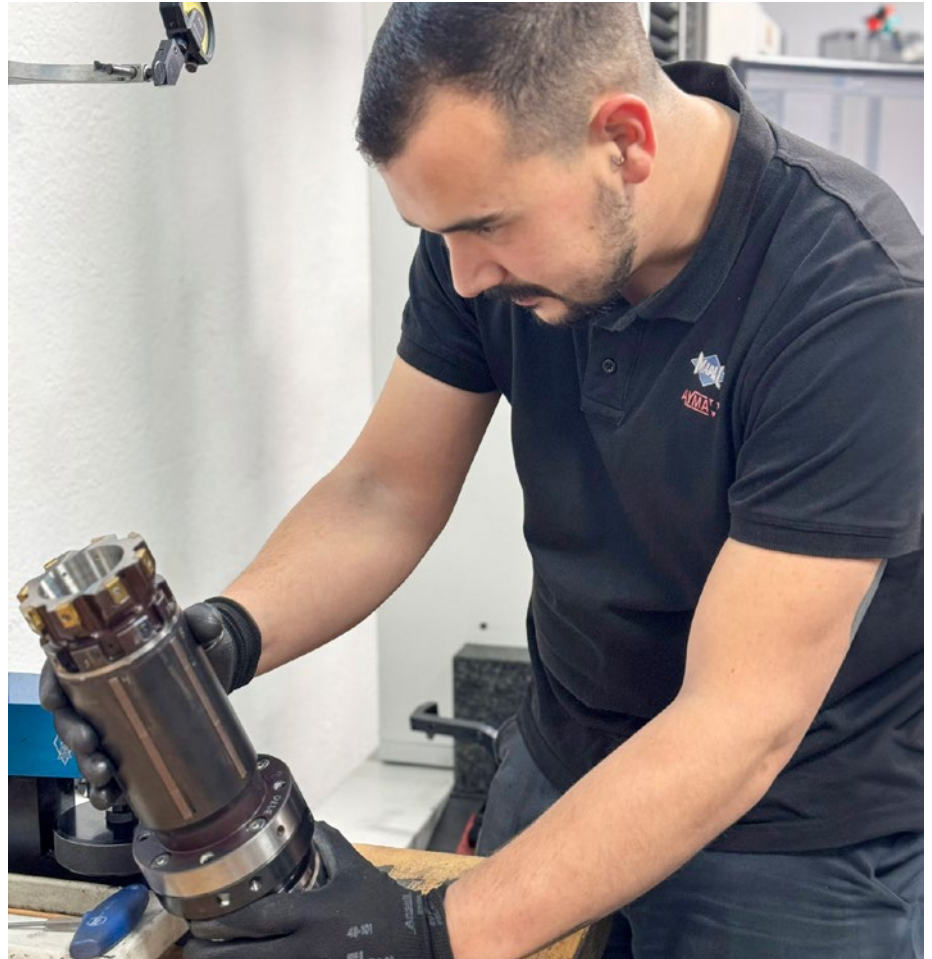
Werkzeugeinsteller Agustin Calado (MAPAL) prüft den mit neuen Wendeschneidplatten bestückten HPR400 für die Fertigbearbeitung der Kurbelwellenlagerasse am Motorblock.
