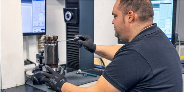
Die HPR400 Reibahle für die Fertigbearbeitung der Kurbelwellenlagerkasse erreicht gegenüber dem Vorgängerwerkzeug die dreifache Standzeit und muss nicht justiert werden. Bei Werkzeuginstaller Sergio Aranda (MAPAL) macht sich das deutlich bemerkbar.
