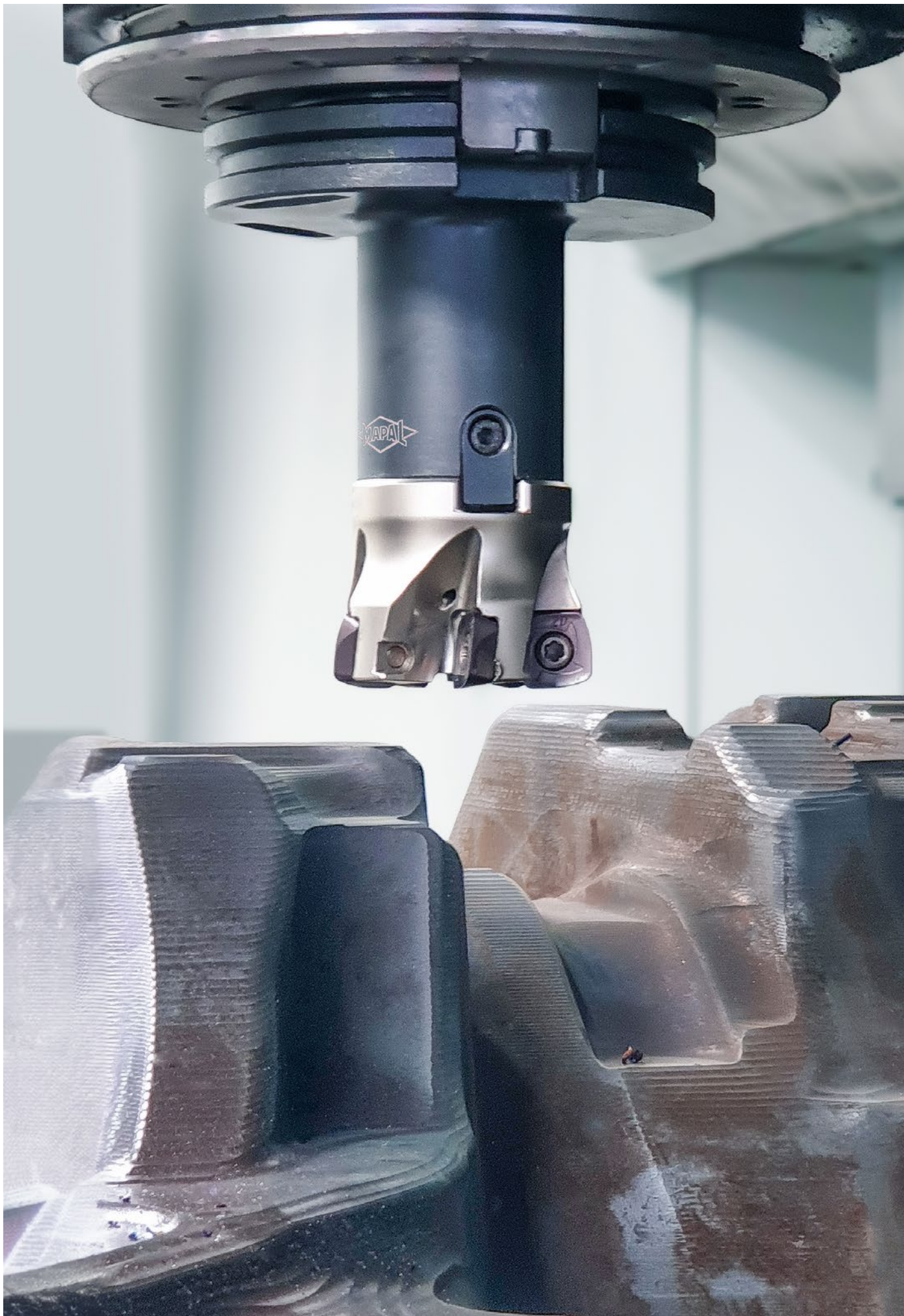
Für das Schruppen der Kokillen nutzt Krämer+Grebe den sechsschneidigen NeoMill-4-HiFeed-90 in der Variante als Aufsteckfräser.
